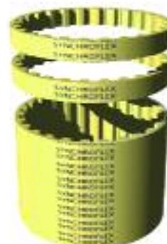
Fertig entformter Zahnriemenwickel, teilweise in Riemen aufgetrennt
